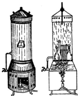
стерилизации питательных сред. Он представляет собой металлический цилиндр с плоским дном и конусообразной крышкой, которая имеет отверстие для выхода пара. Аппарат покрыт теплоизолирующим материалом. Сосуды с питательными средами ставят на подставку, находящуюся внутри аппарата.
