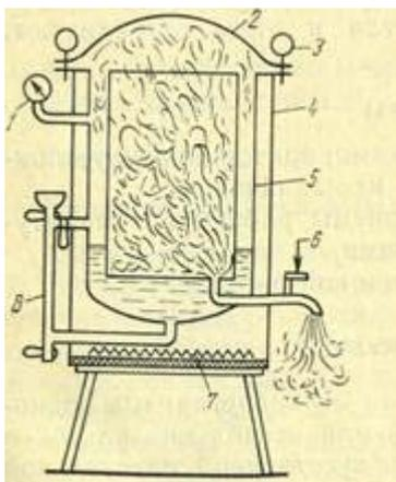
**Автоклав** используют для стерилизации посуды и питательных сред паром под давлением. Это герметичный котёл с двойными металлическими стенками и крышкой. Он снабжён манометром, предохранительными клапанами и краном для спуска воды и пара. Применяют для стерилизации питательных сред под давлением 0,5-1,0 МПа в течение 20-30 мин.
