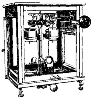
**Весы** в лаборатории необходимо иметь технические и аналитические. Технические имеют точность до 0,01г; аналитические – до 0,001г.
